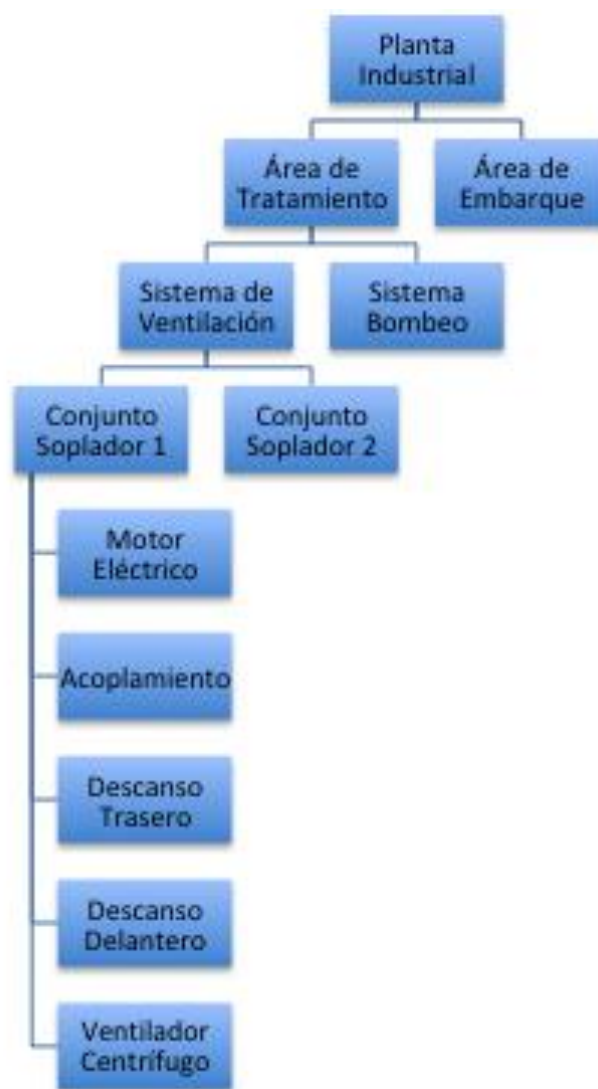
Figura 9.2: Ejemplo de árbol de equipos
