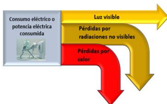
Figura 10.5.1: Diagrama de transformación de energía eléctrica en luminosa
