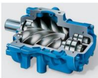
Figura 10.6.3: Corte de la carcasa mostrando los dos tornillos
