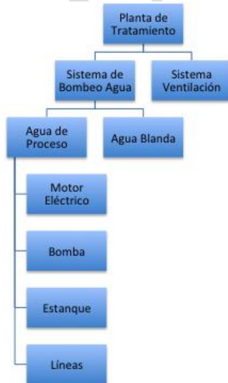
Figura 10.2.5: Árbol de equipos sistema bombeo
